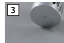
仕上げマグで適切放熱。接合完了の刻印で目視管理。
