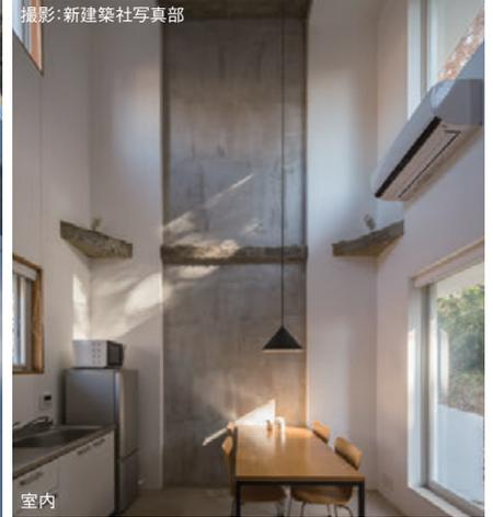
▲大空間になった室内。屋根裏がないため、屋根上にも断熱材を敷設しています。
